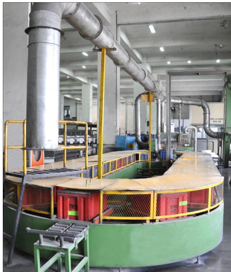
Смесительная установка – автоматически Взвешенное добавление полимеров
